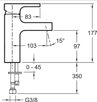
Kurzbeschreibung: Einhebel-Waschtischmischer. 98339D. Kollektion: STRAYT. Gewicht: 2,7 kg. Flow rate: 5 l/min.. Height under spout: 97 mm. Mechanism: Keramik-Kartusche. kalkabweisender Luftsprudler. ohne Exzenter-Ablauf. Keramik-Kartusche. Durchflussmenge: 5 l/min..
